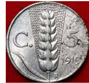
Rovescio della moneta in ferro-nichel da 5 cent. 1919 "Spiga", da notare sulla destra i difetti di fabbricazione sulla superficie del tondello (collezione Gérard J.)
